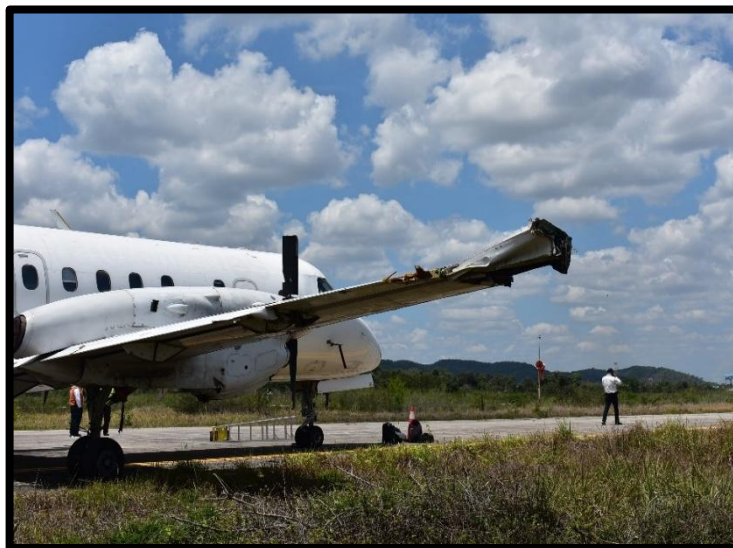
Fotografía No. 8 Vista lateral derecha, daños en el ala.
