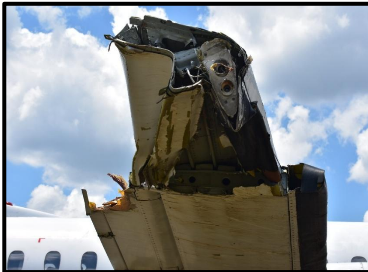
Fotografía No. 9 Vista de los daños en la punta del ala derecha.
