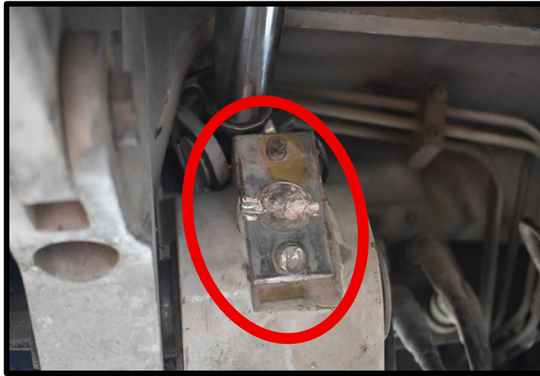
Fotografía No. 11 Acercamiento de los daños en soporte del actuador del tren de aterrizaje.
